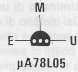
Fig.11 Connessioni dell'integrato LM.231 viste da sopra e dell'integrato uA.78L05 viste da sotto.
