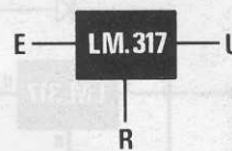
Fig.1 Connessioni dell'integrato stabilizzatore LM.317.
