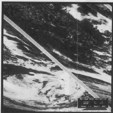
Fig.31 Se la prima volta che capterete l'immagine del Meteosat apparirà inclinata, premete A, poi / (barra) ed in questo modo vedrete apparire una sottile riga verticale.
