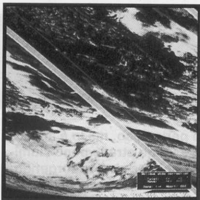
Fig.32 Spostate questa riga tenendo pigiato il tasto Ctrl ed agendo sui tasti freccia. Lasciate il tasto Ctrl ed inclinate questa riga con i tasti freccia sulla riga del sincronismo.
